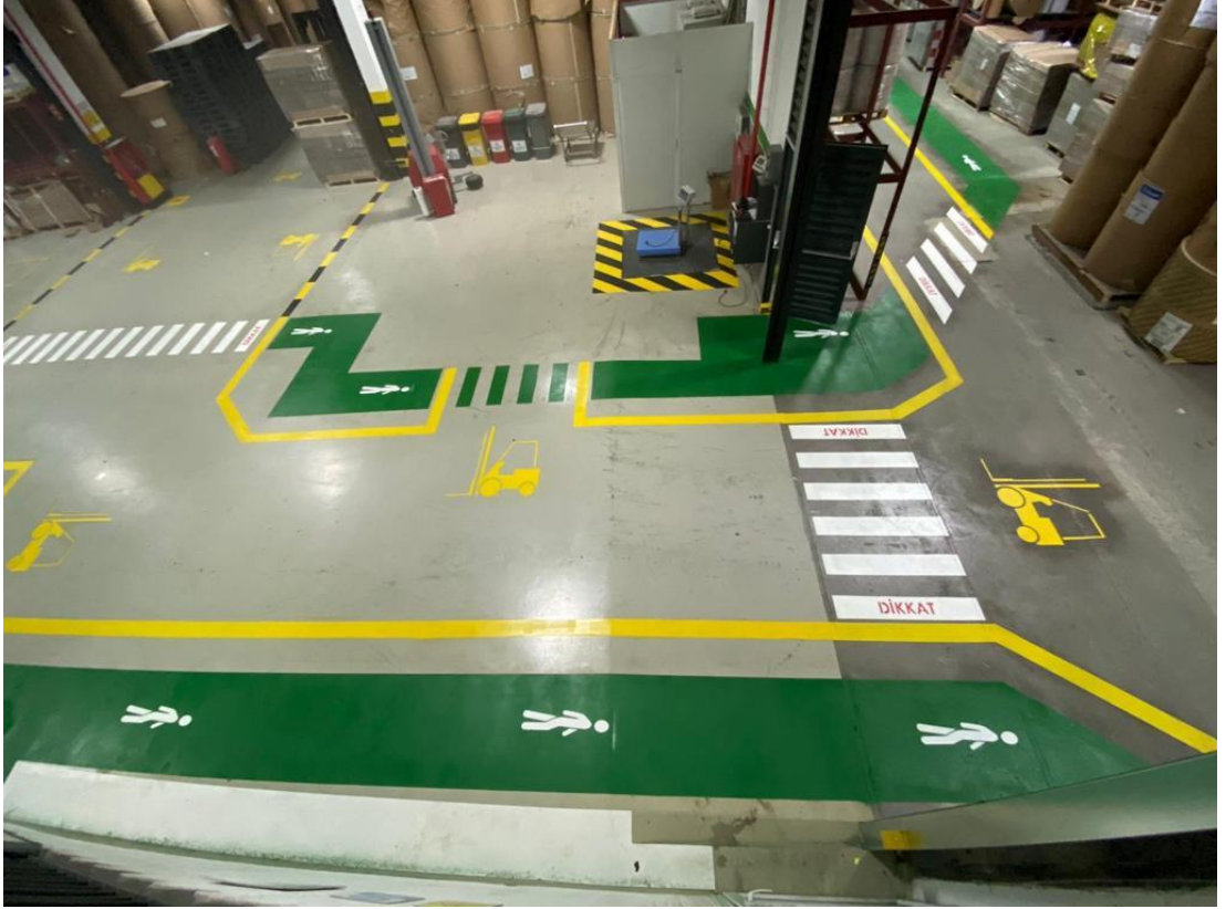
Şekil 3.2: Yaya ve forklift trafiğinin düzenlendiği örnek bir işaretlemesi
