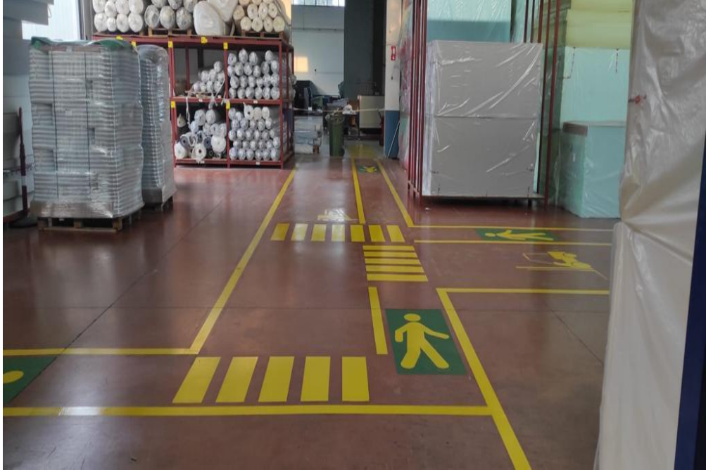
Şekil 3.3: Doğru bakım yapılmış örnek yürüyüş yolu
